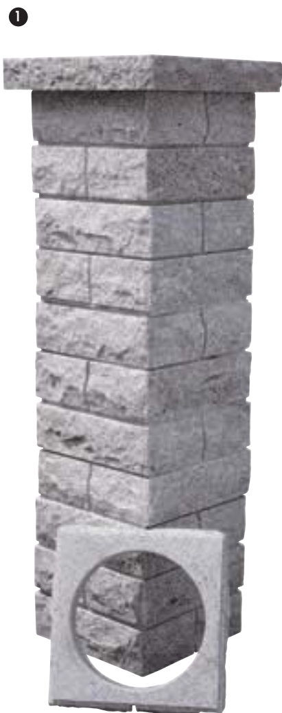
1 Mod. POLO 43 Dimensioni elemento Dimensions de l'élément cm 43 x 43 x 14 h Foro interno / Orifice intérieur Ø cm 33 Copripilastrò / Couvre-pilier cm 53 x 53 x 8 h Materiale / Matériau: Granito grigio o giallo Granit gris ou jaune
